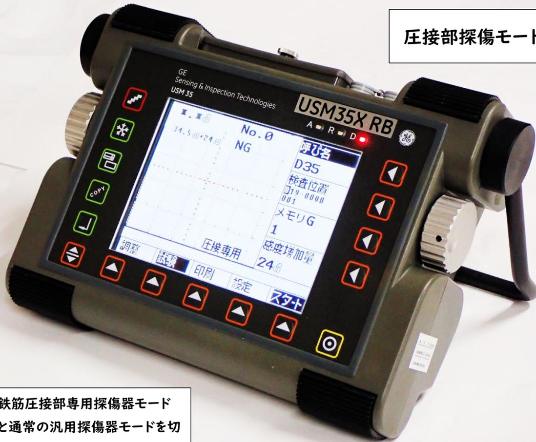
鉄筋圧接部専用探傷器モード
