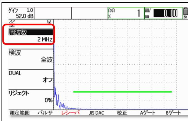
表面 SH 波探触子には 5MHz と 2MHz の製品があります。使用する探触子の周波数に設定
