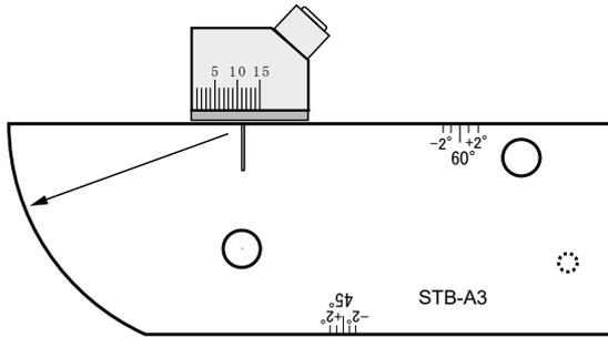
【簡略校正でもほぼ問題なし！】従来の講習会等では音速を 3230m/s に設定し、これが正しいことを前提として、STB-A3 の 50R エコーのビーム路程の読み値を 50.0mm と表示されるように探触子ディレイ（0点調整）を調整することにより校正を行いました。この方法でも二点校正と大きな測定差異は生じません。
