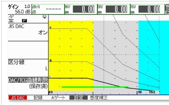
DAC 曲線削除機能部が (保存済) から (曲線なし) に変わり、DAC 線が削除される。JISDAC 機能の表示もオンからオフに変化する
