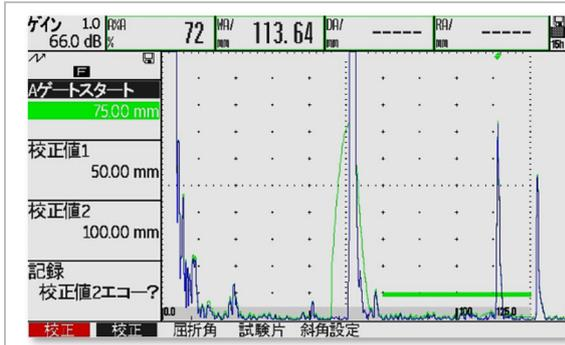
左ロータリーノブ (Gain) で STB-A3 の B2 エコー (ビーム路程 100mm) を 70~80%に調整
