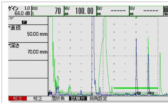
屈折角の測定を行うためホームキー
