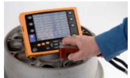
航空機のホイールタイロルト穴のロータリ検査
